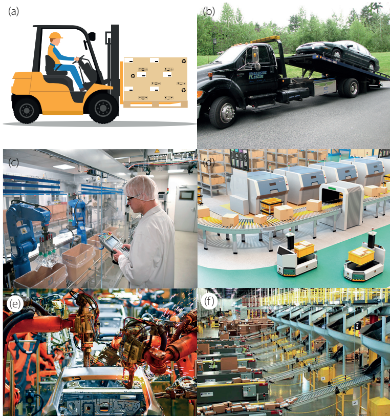
Figura 1. Exemplos de alguns dos equipamentos utilizados nos diferentes tipos de sistemas de manuseio de materiais: (a) empilhadeira; (b) veículo de reboque; (c) robôs apoiados por intervenção humana; (d) esteiras rolantes, dispositivos de separação automatizados e veículos guiados automaticamente; (e) automação — equipamentos que funcionam sem a necessidade de intervenção humana.
